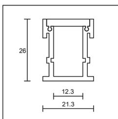
**MC-2126M2** LED Bodeneinbauprofil
